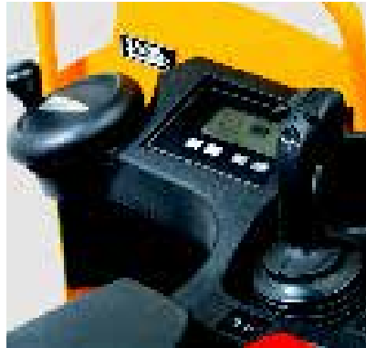
Todas las funciones de accionamiento y de elevación se controlan por medio de la palanca de mando multifunción.
